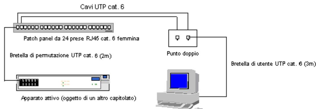
Come si può osservare, ogni attacco di utente deve essere connesso con l’armadio di nodo tramite una coppia di cavi UTP (cavo in rame per la distribuzione orizzontale), le cui specifiche sono riportate di seguito.
